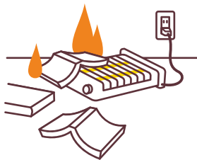
復電後、電気機器に落下した 可燃物から発火
